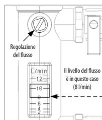
(3) - Regolare il livello del flusso fino a raggiungere la corretta lettura sul misuratore di portata.
