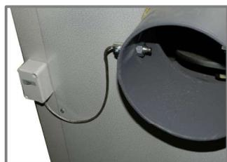
Per il corretto funzionamento del termometro del gas di scarico è molto importante la sua pulizia. Quando si pulisce lo scambiatore di calore rimuovi sempre delicatamente la polvere dal termometro.
