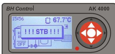
Il guasto "STB" è causato dal surriscaldamento della caldaia. Quando ciò accade, il fusibile termico è attivato e la ventola viene scollegata dall'alimentazione (fig. 3/7). La caldaia può essere accesa solo se il fusibile STB viene ripristinato manualmente (immagine), e solo quando la temperatura della caldaia scende sotto ai 60°C. Per accendere il caldaia premere il tasto "ENTER".
