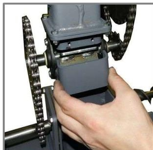
L'erogatore del pellet nella camera (laccio) è il dispositivo progettato per trasferire la quantità richiesta di pellet nell'alimentatore e creare uno spazio d'aria separato sopra l'alimentatore stesso. La costruzione del conduttore utilizzando la catena di trasmissione eviterà che il pellet possa prendere fuoco dentro al serbatoio. Questo design offre anche un facile controllo e pulizia, se il laccio è bloccato con oggetti indesiderati.
