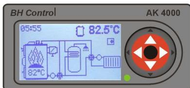
Usa il controllo grafico. Il driver apparirà dopo aver premuto brevemente il tasto centrale ENTER. Il driver grafico offre l'opzione per spegnere la caldaia, l'opzione per aggiungere carburante o per annullare il driver.
